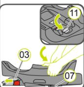
4. Tirare la leva grigia (11) nella direzione della gamba di supporto (07) fino a quando i bracci di arresto ISOFIX (03) sono usciti completamente.
